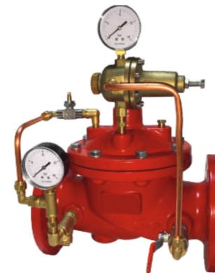
Basınç düşürücü hidrolik kontrol vanaları, su iletim şebeke hatlarındaki yüksek basınç değerini istenilen daha düşük bir değere düşürmek için kullanılır. Basınç düşürücü kontrol vanaları, şebedeki akış ve debi değişimlerinden etkilenmeden ayarlanan çıkış basınç değerini korur. Vana çapı seçimi yapıldıktan sonra boru çapı dikkate alınmaz. Vana çapı boru çapının küçük veya bir büyük değerinde seçilebilir. Vana çapı seçimi yapıldıktan sonra kavitasyon değerleri dikkate alınmalıdır.
