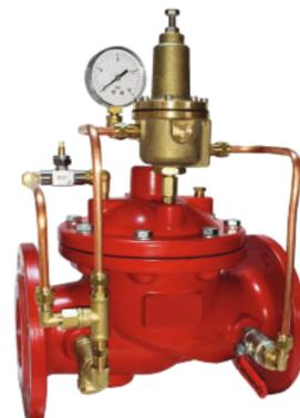
Hızlı basınç tahliye kontrol vanaları; sisteme basıncın belli bir limit değerinin üzerine çıktığında, açılarak fazla basıncın dışarı atılması ile sistemi rahatlatmak için kullanılır. Sistem basıncı vananın ayarlı olduğu limit değerine düşüğünde vana tekrar kapanır. Relief vanaların basınç değeri üzerinde kullanılan pilot valf sayesinde ayarlanır. Pilot valfin ayarlanan set değeri çıkışındaki geri basınçtan etkilenmez.
